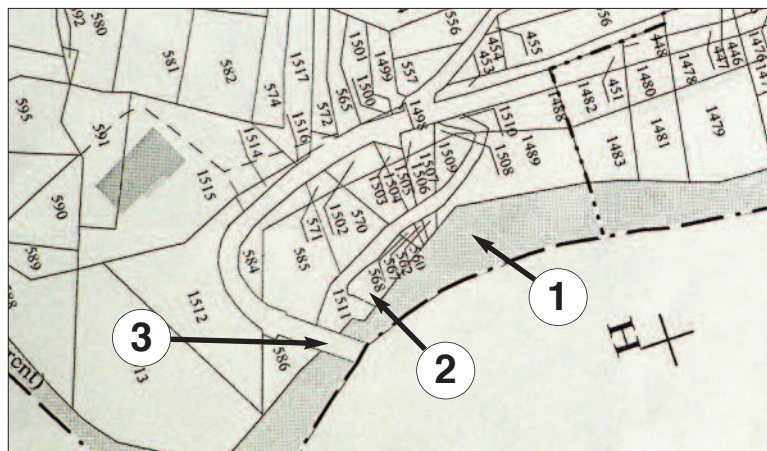
■ Plan II. Cadastre de Saint Alban des Villards, mise à jour 2006 (section N) : 1 : emplacement du pont de 1730 ; 2 : emplacement du pont de 1867 ; 3 : le pont construit en 1905.
